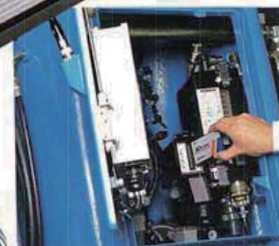
自動運転の心臓部。名刺大のICカードに施工ノウハウを集約しました。
